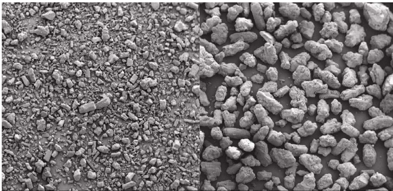
Рис.5 Тридцатикратное увеличение. Слева – пищевая сода, купленная в магазине. Справа – крупнозернистая сода для струйной очистки поверхностей.
