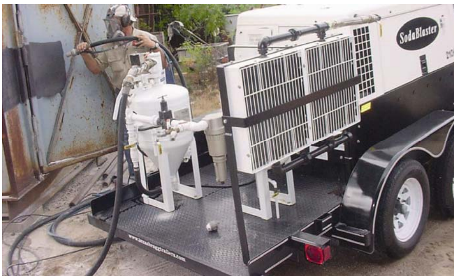
Рис.6 «Сода-бластер». Передвижной аппарат струйной очистки поверхностей при помощи соды.
