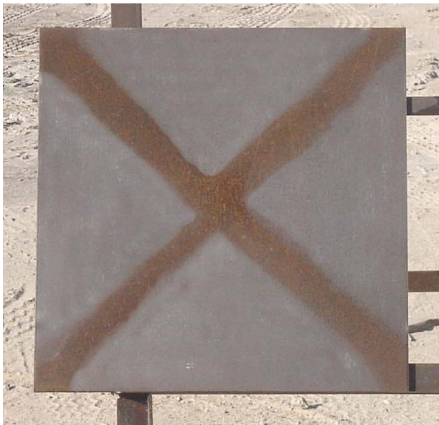
Рис.3 Через 3 недели зона «X», обработанная пескоструйным аппаратом покрылась легкой и средней ржавчиной, тогда как остальная часть пластины, обработанная содой, осталась без изменений.
