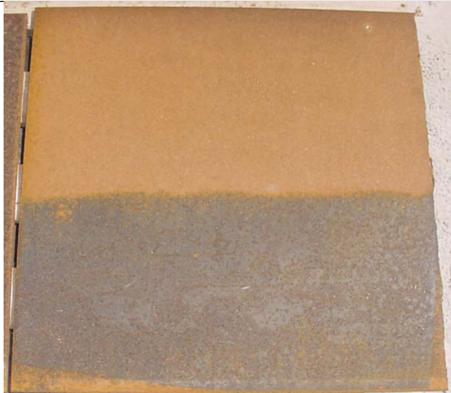
Рис.4 Верхняя часть пластины обработана песком, нижняя – содой. Спустя 2 месяца верхняя часть значительно проржавела, тогда как нижняя половина осталась практически без изменений.
